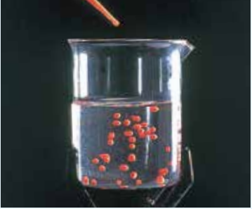
球形ゼリー作成の例 アルギン酸Na 1%水溶液+オレンジ色素を1%CaCl 2 水溶液中に滴下
