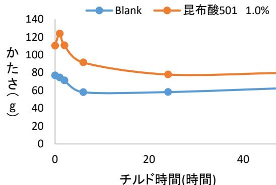
10分間茹で、冷水で冷却した麺を冷蔵庫内に静置し、各時間で取り出した時のかたさをテクスチャーアナライザーで測定。
