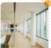
ダブルスキン窓の内側にブラインドを設置、その内側にガラスをはめ込んだ三重窓で断熱性能を飛躍的に高めています。さらに、ブラインドの自動昇降で直射日光を遮断し、屋外からの熱と紫外線の侵入をシャットアウト。景色を望む開放的なガラス張り空間と、安定した試験環境を両立させました。
